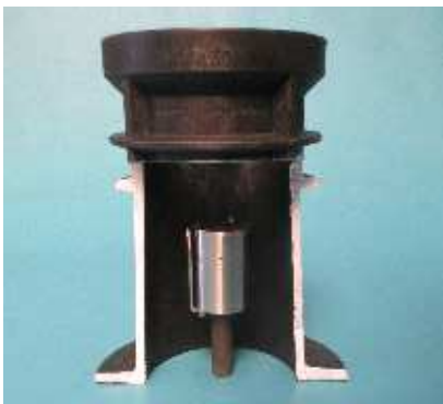
BASTA Kleinste Öffnung der Straßenkappe für Größe A mindestens 80 mm \varnothing Größe B mindestens 120 mm \varnothing
