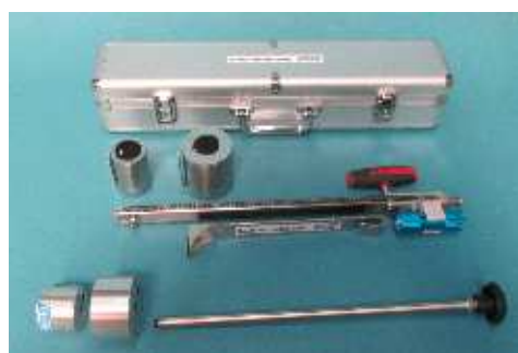
Schmales Montage-/Demontage Spezialwerkzeug (für Größe A u. B). Zur Klemmblockbefestigung innerhalb der Schieberkappe (Aus Sicherheitsgründen Schlüssel-form am unteren Ende retuschiert)
