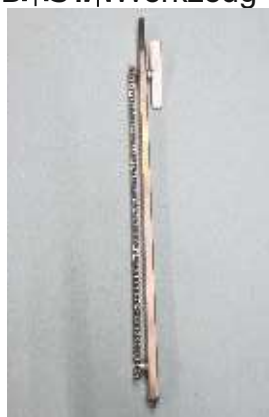
Schmales Montage-/Demontage Spezialwerkzeug (für Größe A u. B). Zur Klemmblockbefestigung innerhalb der Schieberkappe (Aus Sicherheitsgründen Schlüssel-form am unteren Ende retuschiert)
